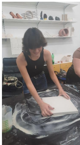
Zaglađivanje površine gipsane ploče
